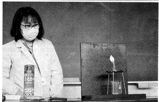
メタンハイドレートの燃焼実験
